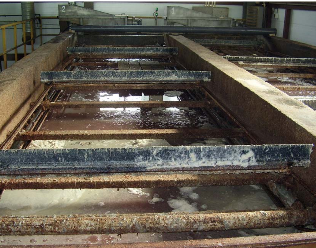
Рис. 1. ФЛОТАЦИОННАЯ УСТАНОВКА ПТИЦЕФАБРИКИ С ПРОБЛЕМАМИ В РАБОТЕ СИСТЕМ САТУРАЦИИ ВОЗДУХА И РАСПРЕДЕЛЕНИЯ ВОДОВОЗДУШНОЙ СМЕСИ
