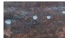
ЭКСПЕРИМЕНТАЛЬНЫЕ ПОВРЕЖДЕНИЯ НА ТРУБЕ, ЗАКРЫТЫЕ НАНЕСЕННЫМ ПОКРЫТИЕМ
