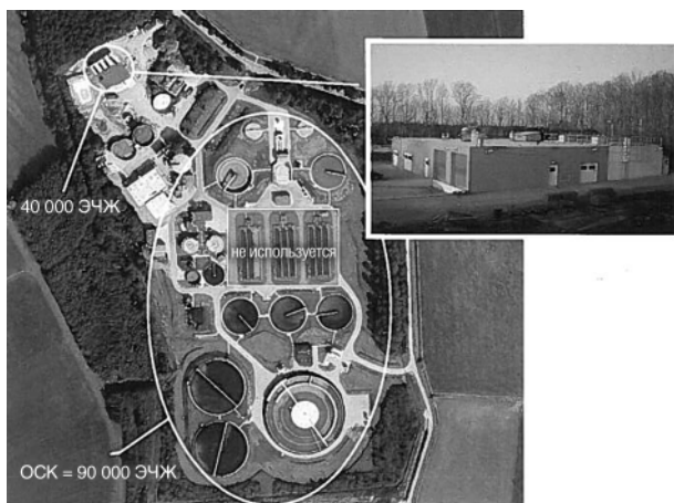
Рис. 1. Общий вид расположенных рядом ЛОС сточных вод ППК и возвратного потока, а также городских ОСК
